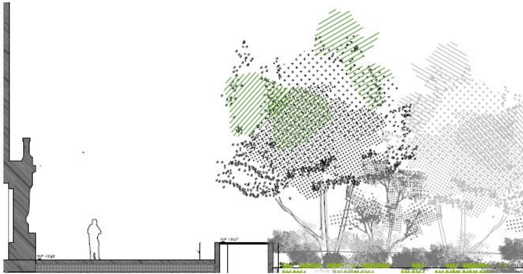
Coupe vue du Jardin de la Nouvelle France, issues de secours situées au Sud-Ouest de la Nef donnant vers une cour en amont à la rampe logistique. En cas d'évacuation, les visiteurs n'auront pas à traverser le jardin. (c) LAN et Base (mémoire en réponse p.14)
